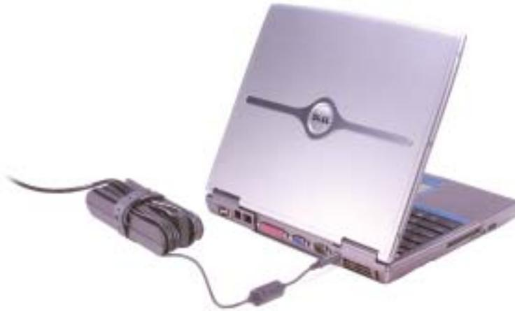
Der Netzadapter wandelt Wechselstrom in den vom Computer benötigten Gleichstrom um. Sie können den Netzadapter bei ein- oder ausgeschaltetem Computer anschließen.
