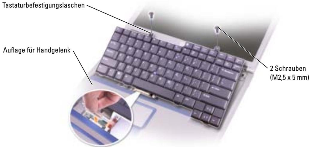
**ANMERKUNG:** Stellen Sie beim Austauschen der Tastatur sicher, dass die Tastaturlaschen ordnungsgemäß ausgerichtet und eingesetzt sind, so dass die Auflage für das Handgelenk nicht zerkratzt wird.
